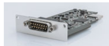
Tarjeta de adquisición de datos para la conexión a las ranuras de expansión de los módulos MDi
